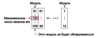
• Если необходимо использовать дискретный вход (DI) из GX90XD или GX90WD, то может быть использован только один модуль, установленный в главный блок GM.
