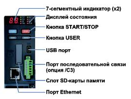
7-сегментный индикатор: Отображает режим работы, № системы, работу самопроверки, блокировку кнопок, ошибку работы, работающий процесс и информацию установки модуля.
